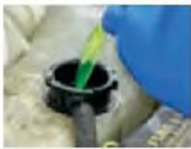
Anticongelante que se agrega al radiador de un automóvil. El anticongelante consiste en una disolución acuosa de etilenglicol, \text{CH}_2(\text{OH})\text{CH}_2(\text{OH}) .
